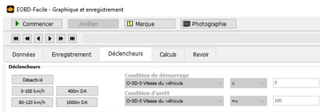
Cette fonction permet de lancer la lecture et l'arrêt de l'enregistrement en mode graphique de manière automatique et suivant une condition. Cette fonction est pratique pour des mesures de performance tel que les DA (départ arrêté) sur un 0 à 100 km/h.
